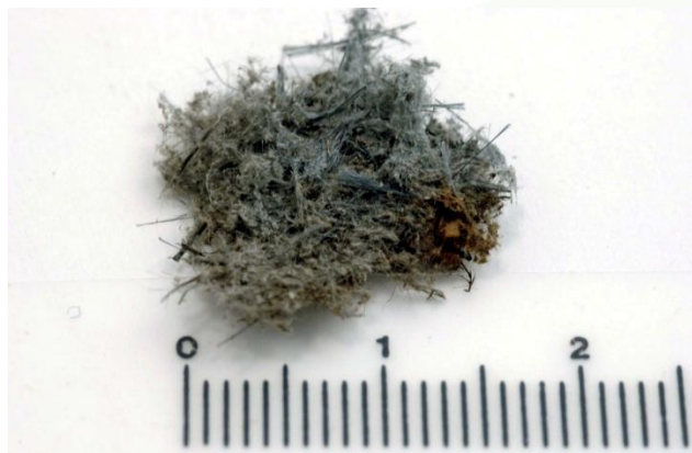
Slika 18: Azbestna vlakna v izolacijskem materialu (vir: ZAG).
