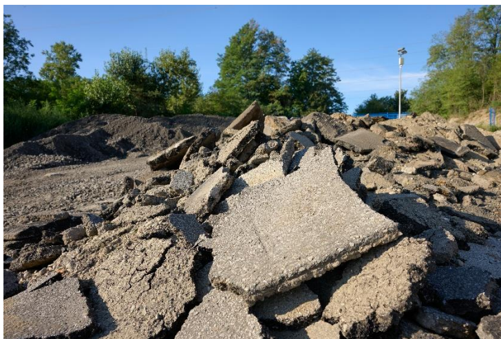
Slika 15: Primer gradbenih odpadkov, odpadnih bitumenskih mešanic, nastalih pri obnovi asfaltnih vozišč (17 03 02), ki se najpogosteje uporabljajo kot reciklirane v cestogradnji (slika: MOPE).
