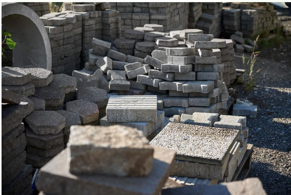
Slika 23: Ročno odstranjeni betonski tlakovci in plošče, ki se shranjujejo za potrebe gradnje in obnove v Mestni občini Maribor v Dogošah, centru ponovne gradnje Javnega podjetja NIGRAD, d.o.o. (vir: MOPE).
