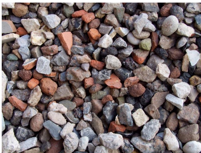
Slika 16: Reciklirani agregat, ki se lahko kot gradbeni proizvod uporablja za različne namene v gradbeništvu, nastal z recikliranjem mešanih gradbenih odpadkov (17 01 07) ter z nadaljnjo obdelavo – proizvodnjo (npr. drobljenje in sejanje v velikostne frakcije) recikliranega agregata (slika: ZAG).
